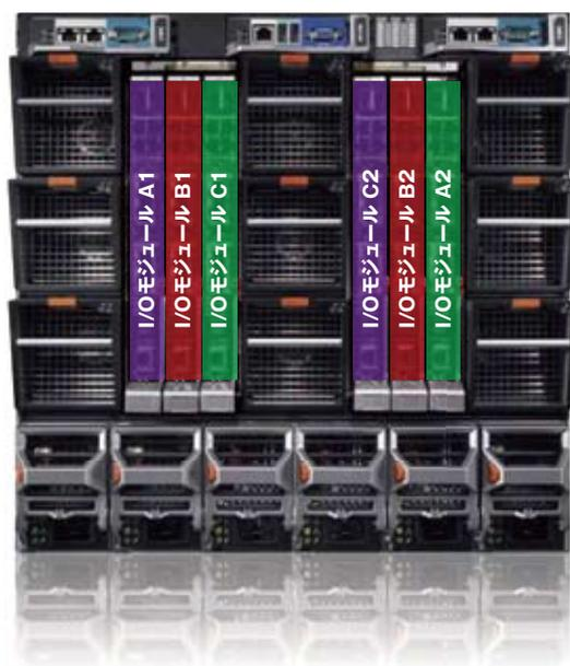
図 1：ブレードファブリック配置図
