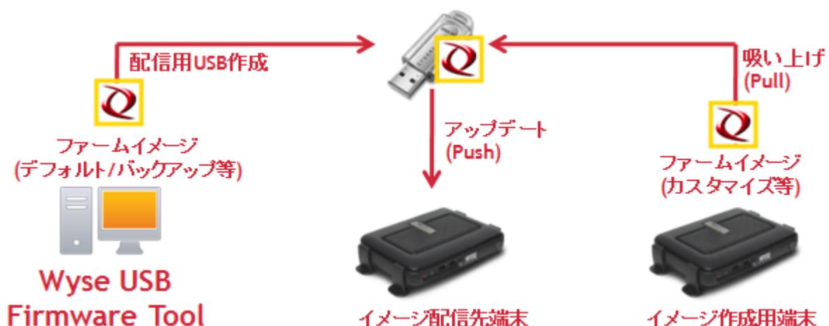
図 1 Wyse USB Firmware Tool ファームウェア更新
