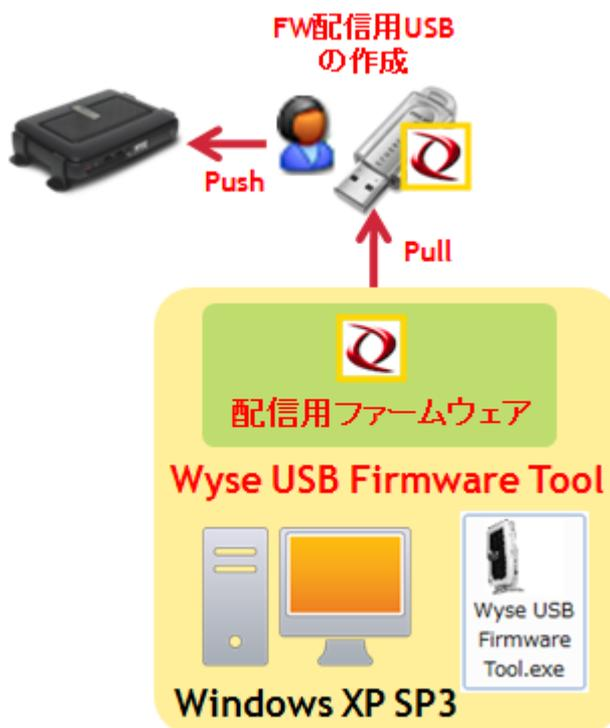
図 5 配信用 USB メモリの作成と端末への配信
