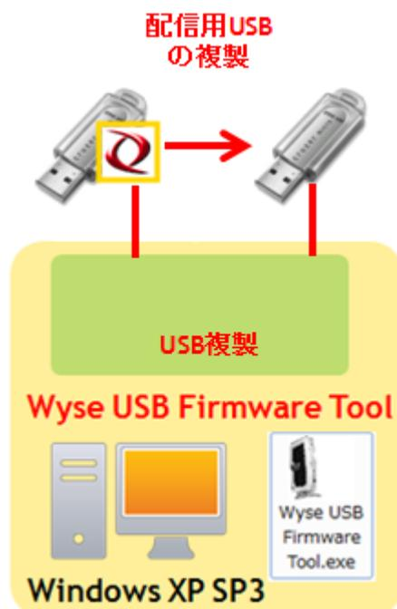
図 29 配信用 USB メモリの複製
