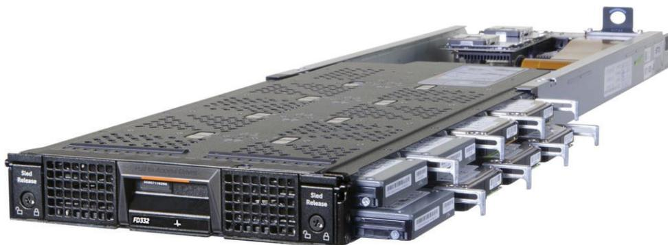
図 5 には当社がテストした Dell PowerEdge FX2 ソリューションの容量効率が極めて高いことが示されています。各 FD332 ストレージブロックでは、FC830 サーバ内に搭載された 8 台の 2.5 インチドライブベイに加えて、最大 16 台の 2.5 インチドライブをサポートできます。当社がテストした、合計 8 台の 2.5 インチドライブベイが利用できる Dell PowerEdge R820 に比べて、サーバおよびストレージブロックを含む Dell PowerEdge FX2 の完全なソリューションは、5 倍に当たる合計 40 台の 2.5 インチドライブベイをストレージに提供できます。
